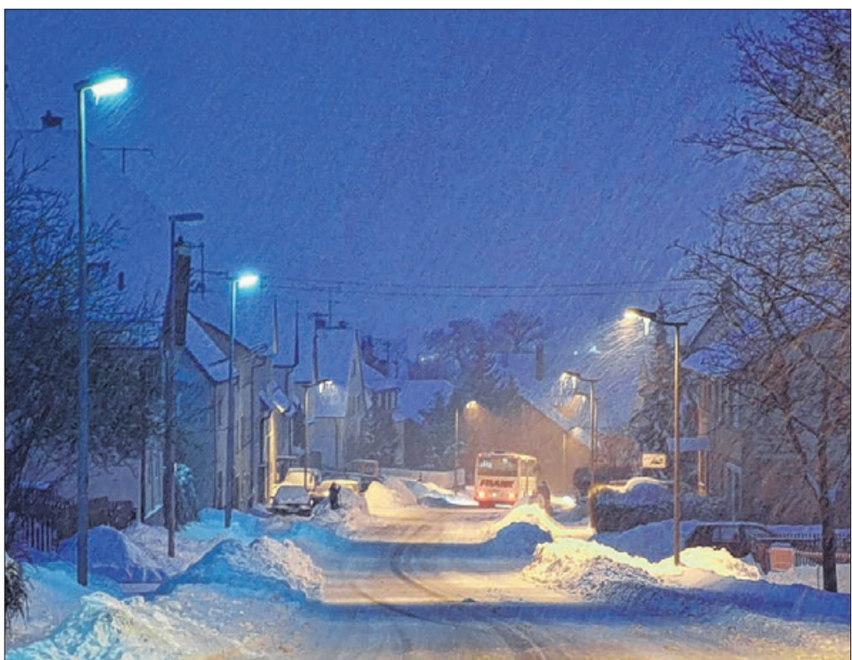
Die Auinger Hauptstraße hat – lichttechnisch – eine gute und eine schlechte Seite: Links kaltweißes Licht in Lampen, die stark streuen ist nicht effektiv, besser die rechte Seite mit gelbem Licht.
